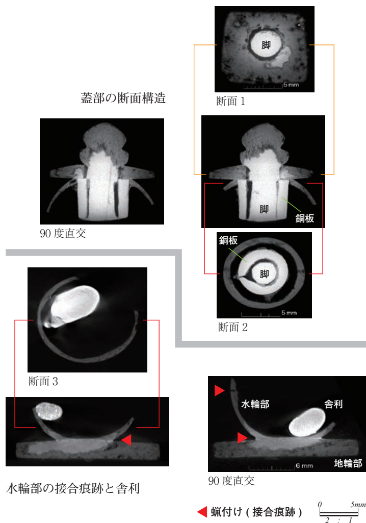
写真1 金銅製舍利容器X線CT画像
